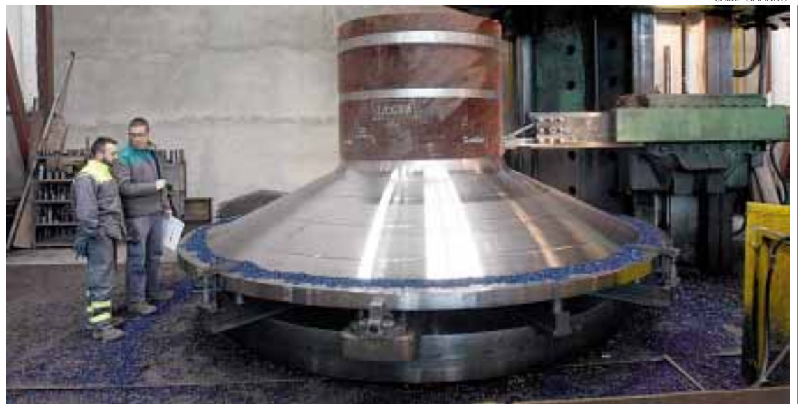
►► Fábrica ► Dos trabajadores manipulan un testero para un molino de cemento en la planta de Zaragoza.
